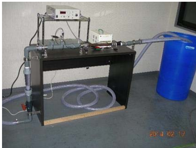
図 2-2.5 KISR に供与した海水熱交換器銅合金管の分極抵抗法モニタリング装置
