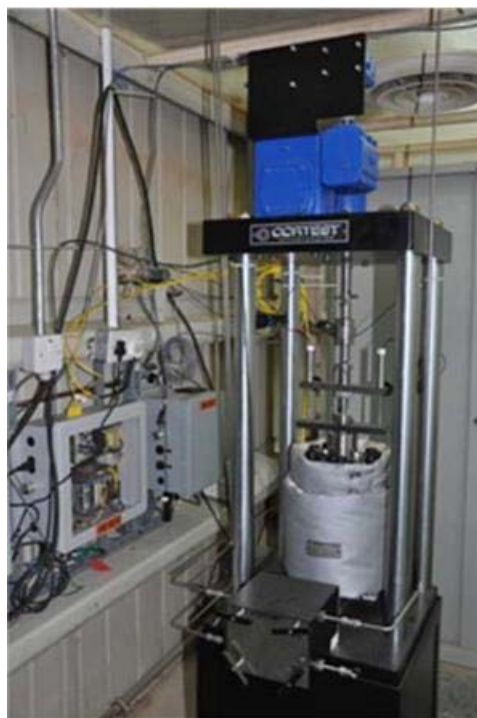
図 2-2.6 KISR/PRC が設置した SSRT 装置
